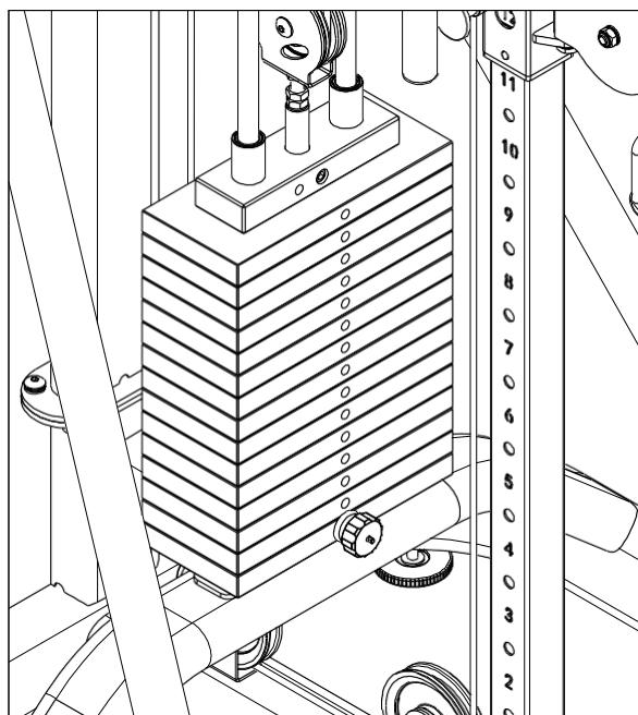
Выберете необходимый вес и вставьте регулировочный штырь в соответствующее отверстие. Вес первого груза 5 кг, второго и третьего по 6 кг, последующих по 10 кг. Конец штыря намагничен, что предотвращает его выпадение.
