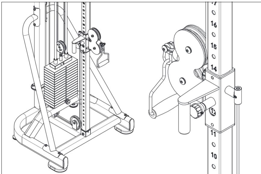
Настройте натяжение троса при помощи регулировочной гайки.
