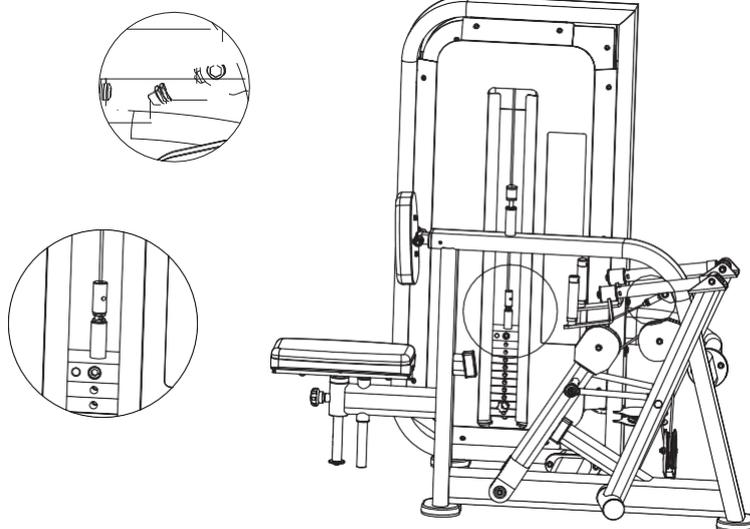
Настройте натяжение троса при помощи регулировочной гайки.
