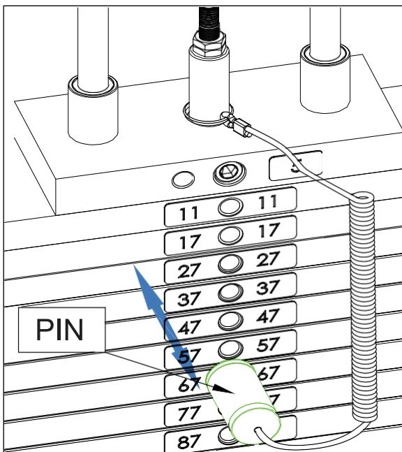
Выберете необходимый вес и вставьте регулировочный штырь в соответствующее отверстие. Вес одного груза 5 кг, второго и третьего по 6 кг, последующих по 10 кг. Конец штыря намагничен, что предотвращает его выпадение.
