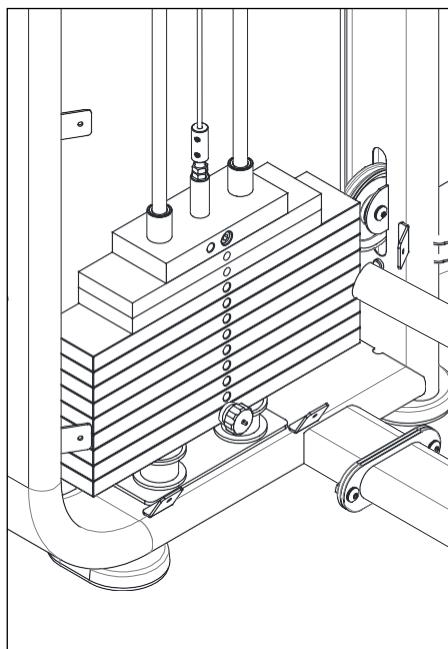
Настройте натяжения троса при помощи регулировочной гайки.
