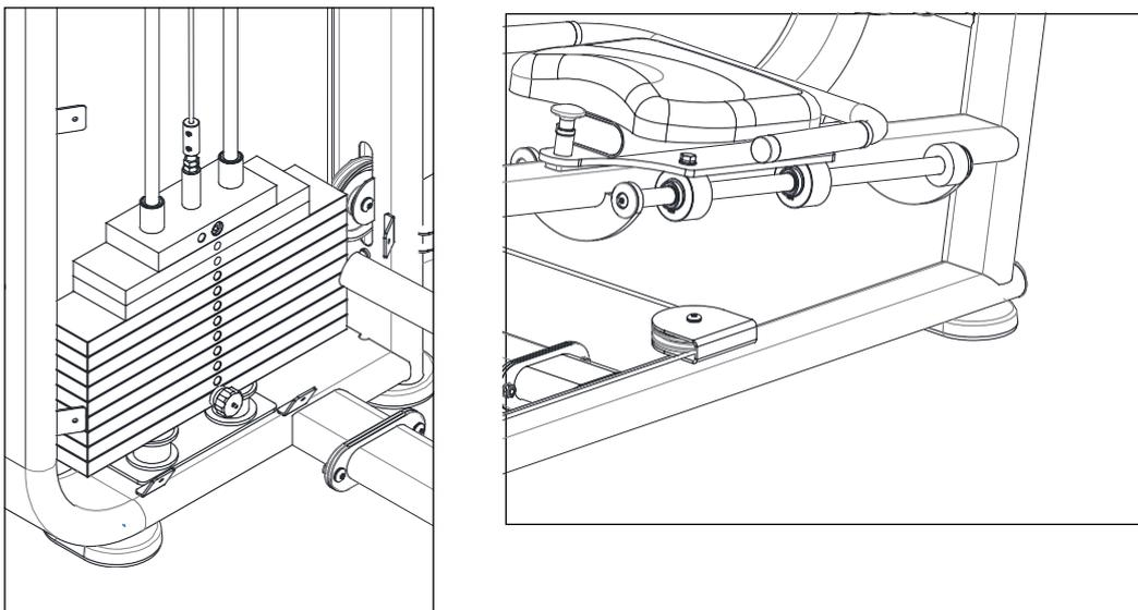
Настройте натяжения троса при помощи регулировочной гайки.
