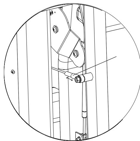
Настройте натяжение троса при помощи регулировочной гайки.
