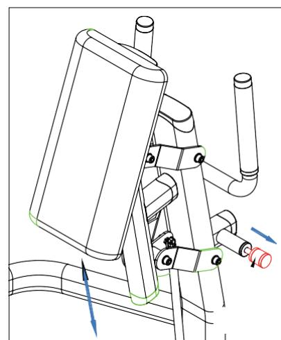
Потяните регулировочную рукоятку и изменяйте высоту установки сиденья.
