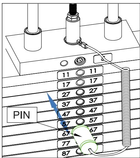
Выберете необходимый вам вес и вставьте селектор веса в соответствующее отверстие. Вес одного груза 5 кг, второго и третьего по 6 кг, четвертого и последующих по 10 кг. Конец селектора намагничен, что предотвращает его выпадение.
